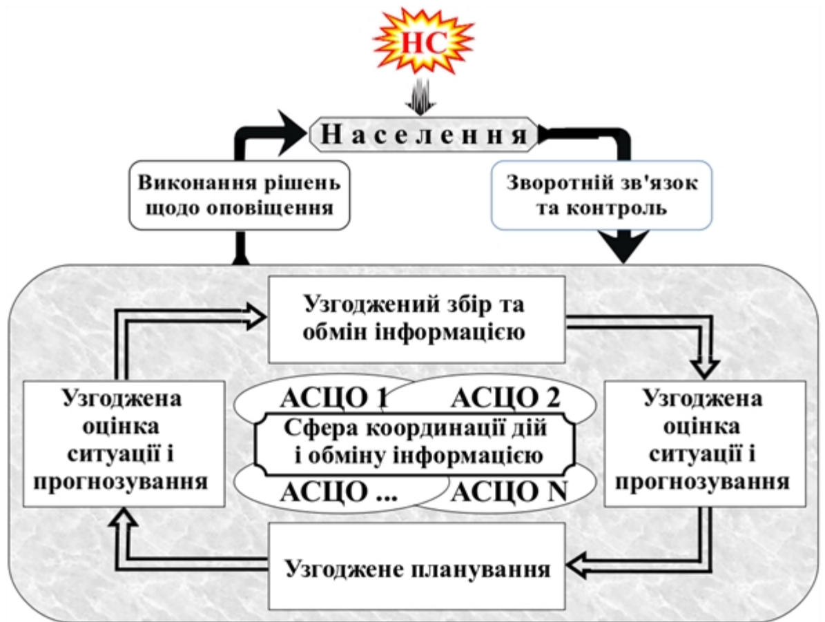
Рисунок 5. Циклограма процесу управління оповіщенням населення
